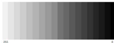
ภาพที่ 4 ระดับแสงของ Gray Scale 256 ระดับ
