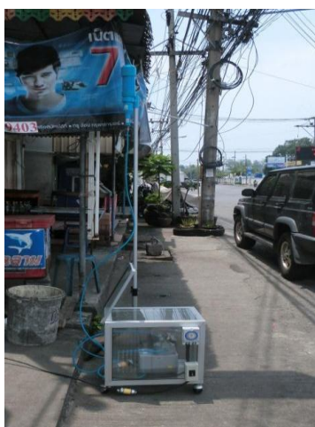
ภาพที่ 3.2 แสดงการติดตั้งอุปกรณ์เครื่องเก็บฝุ่นละอองอย่างง่าย ณ ถนนทะเลหลวง
